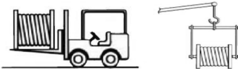
**Figura 1.7b** - Esempi di corretta movimentazione mediante carrello elevatore e gru
