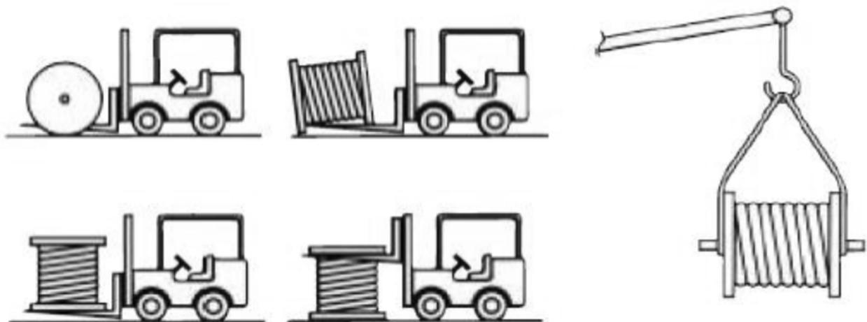
**Figura 1.7c** - Esempi di movimentazione delle bobine da evitare
