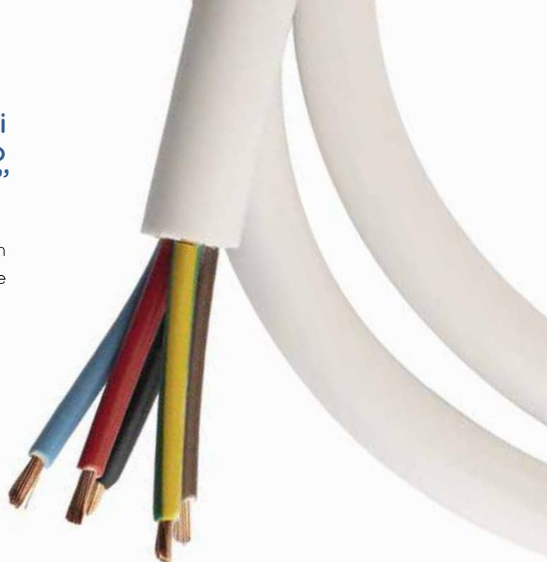
I cavi aventi classe di reazione al fuoco **B2<sub>ca</sub>-s1a,d1,a1** sono particolarmente adatti all’installazione a fascio in luoghi in cui è fondamentale, in caso d’incendio, limitare al minimo gli effetti della propagazione dello stesso e le emissioni di fumi opachi e gas acidi, al fine di poter assicurare un’evacuazione sicura delle persone dai locali salvaguardando inoltre apparecchiature, strumentazioni e strutture metalliche.
